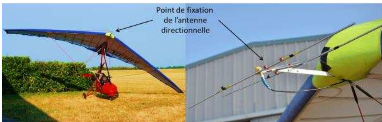
Figure 28 : ULM équipé pour le suivi télémétrique.
